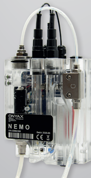
NEMO: Micro-laboratorio IoT per analisi qualità e impronta dell'acqua in rete
